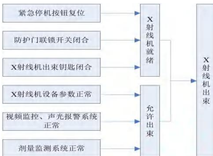
图 9-5 安全联锁逻辑图
