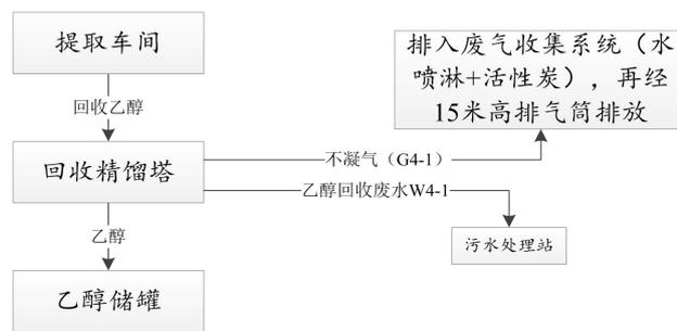
图2-8 乙醇回收工艺流程和产污环节
